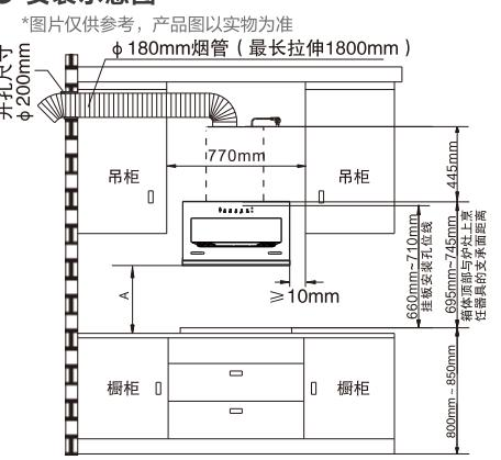
吸油烟机的出风口到排气孔的距离不宜太长，以小于1.5m为宜，且转弯数量不应多于2个。
